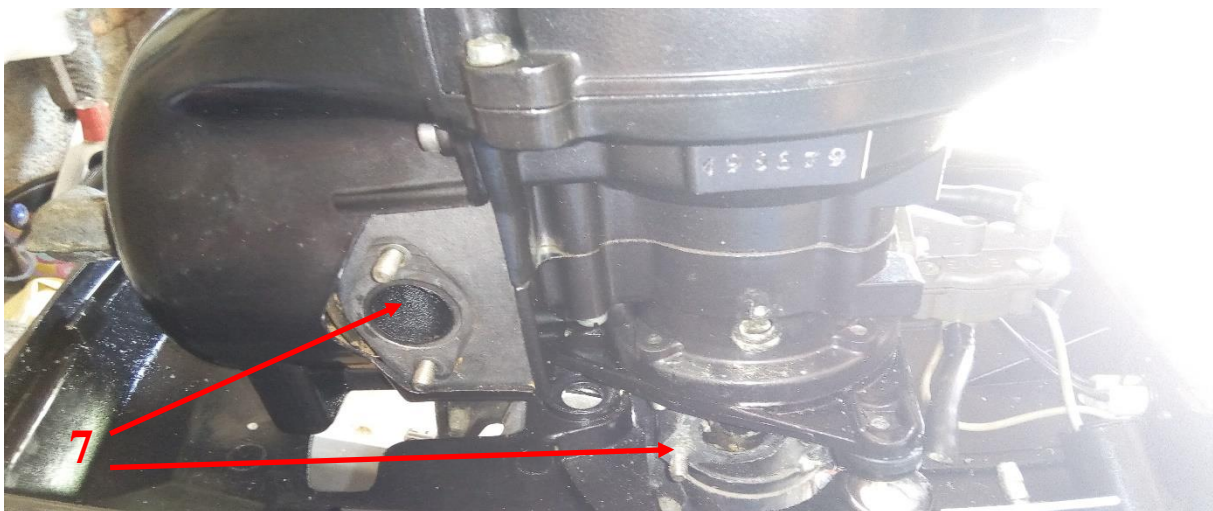
Slika 4.6. Mjesto montiranja ispušne cijevi (7)
