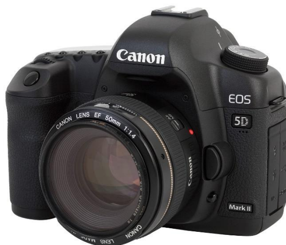
Slika 4.18 - Canon EOS Mark II - Prvi 35-milimetarski full frame fotoaparatusposoban za snimanje 1080p videa [49]
