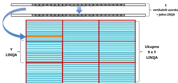
Slika 5.14- Mreža za uzorkovanje za sustav za autofokus kod kamere C300 Mark II [52]
