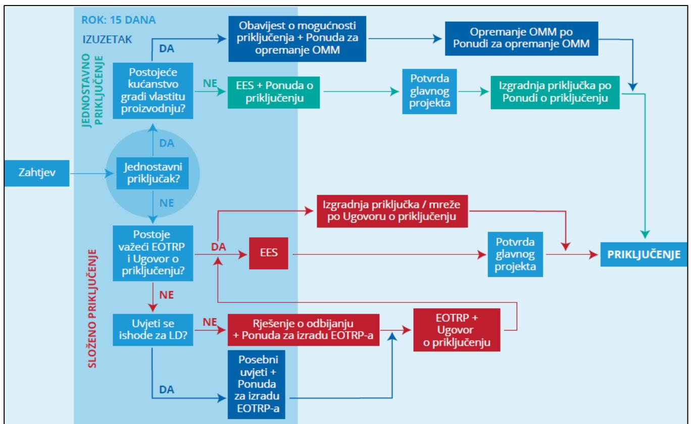
Slika 11. Proces priključenja za jednostavne i složene priključke [10]
