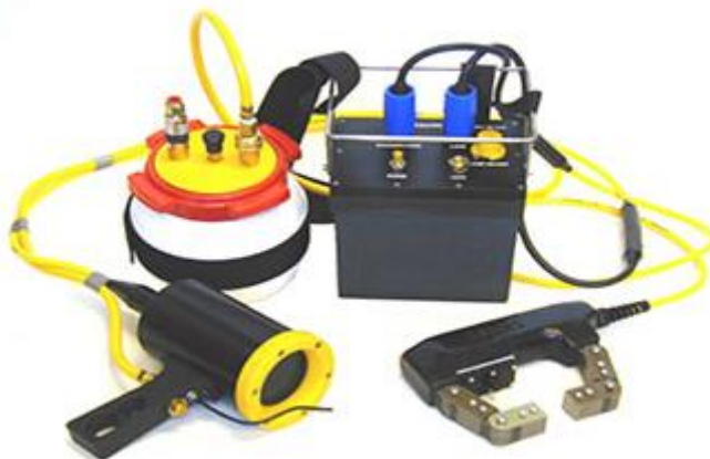
Slika 41. Podvodni sustav za kontrolu magnetskim česticama [43]
