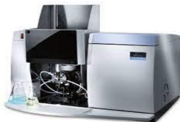
Slika br. 15 - AAnalyst 400 -FAAS (Super-lab)
