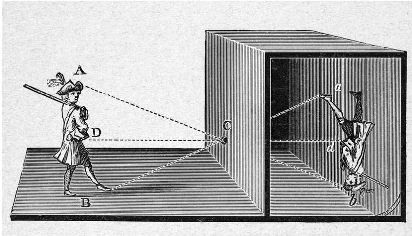
Slika 2.1. Na in funkcioniranja camere obscurae, preuzeto s: [rb.gy/2iobl](http://rb.gy/2iobl)
