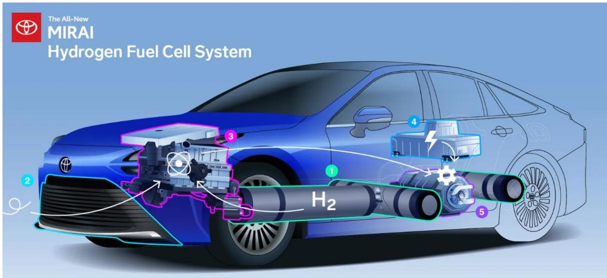
Slika 16. Prikaz automobila na gorive čelije (Toyota Mirai sa glavnim komponentama)[40]
