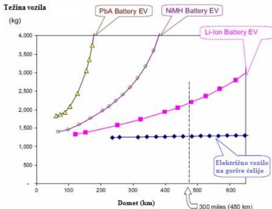
Graf 5. Usporedba električnih automobila: Baterije vs. Gorive čelije[10]
