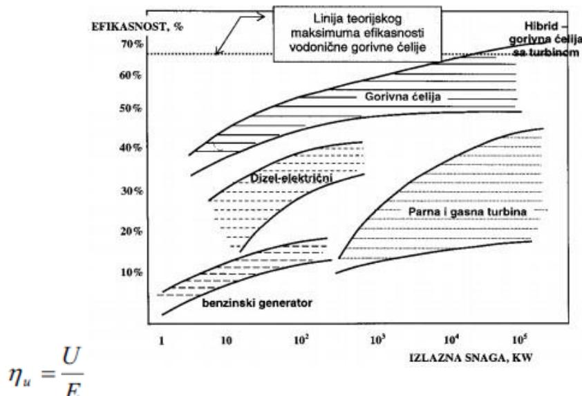
Graf 1. Efikasnost različitih sistema za transformaciju energije u električnu energiju[43]
