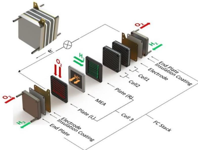
Slika 9. Shematski prikaz gorivih čelija [33]
