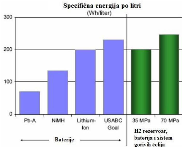
Graf 6.. Usporedba električnih automobila: Baterije vs. Gorive čelije, Specifična energija po litri[10]
