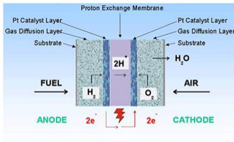
Slika 7. Princip rada PEM gorive čelije [31]
