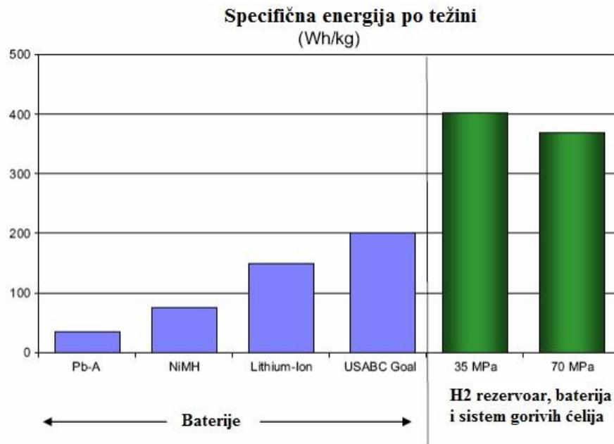
Graf 4.. Usporedba električnih automobila: Baterije vs. Gorive čelije [10]
