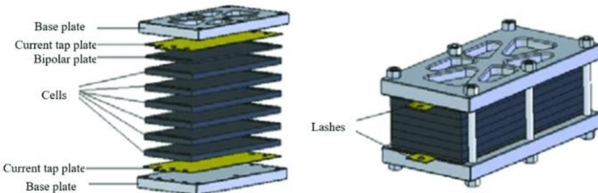
Slika 11. Konstrukcija bloka gorivih čelija u presjeku [35]
