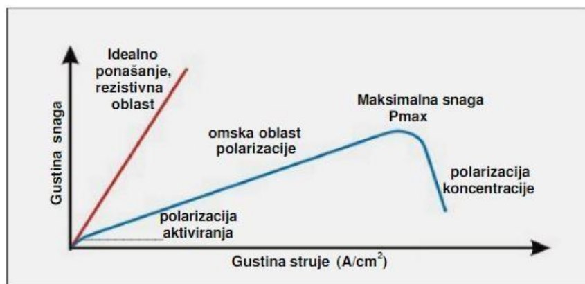
Graf 2. Ovisnost gustoće snage od gustoće struje gorivih ćelija [10]
