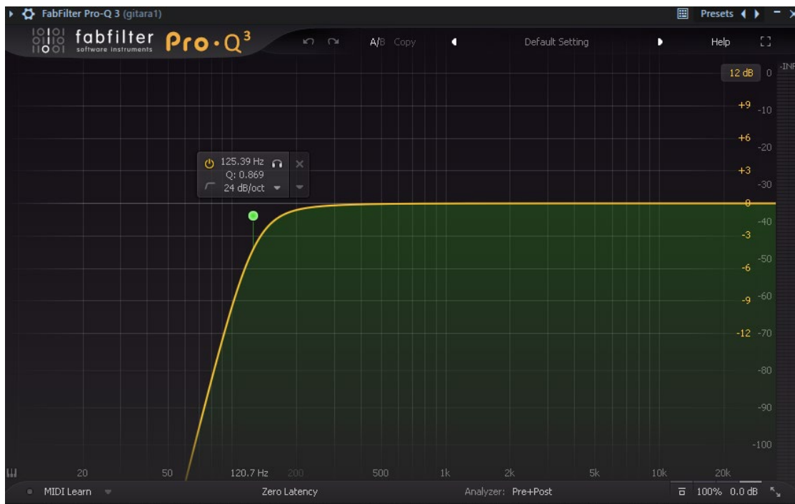
Slika 8.2.1. Rezanje donjeg dijela frekvencija
