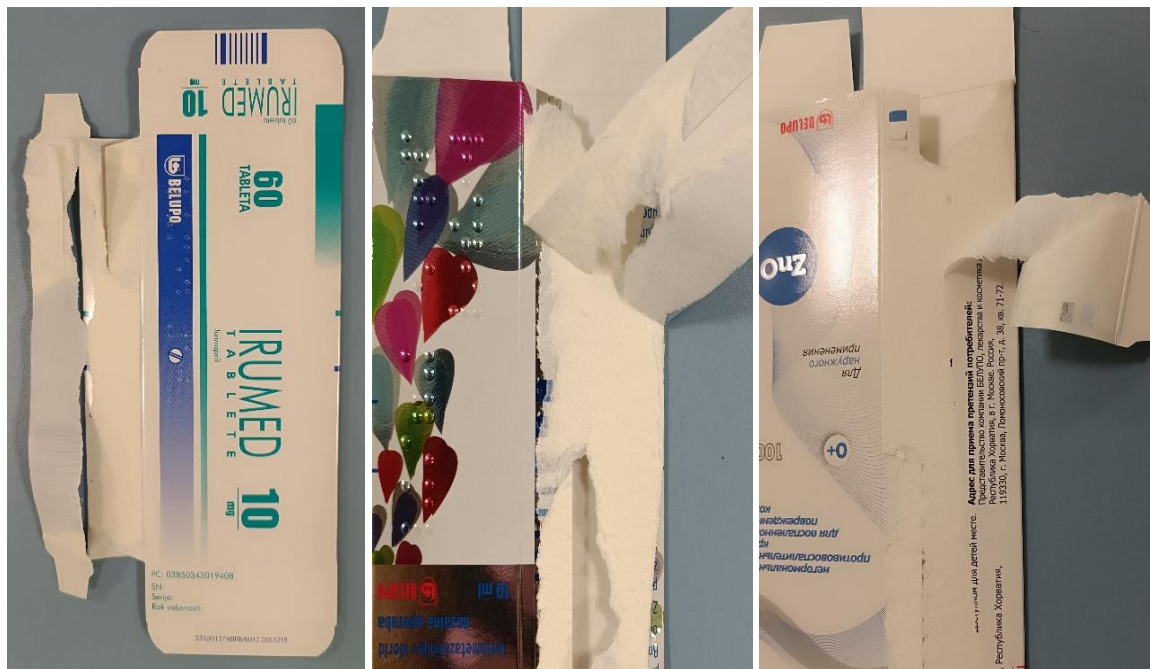
Slika 5.9 Ispitivanje lijepljenja analiziranih kartonskih kutija
