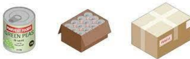
Slika 2.9 Primjer primarne, sekundarne i tercijarne ambalaže
