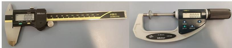
**Slika 5.2** Pomična mjerka
