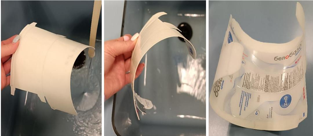
Slika 5.6 Ispitivanje smjera vlaknaca analiziranih kartonskih kutija
