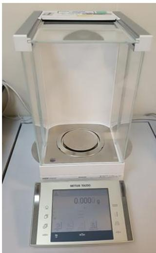
**Slika 5.5** Analitička vaga Mettler Toledo
