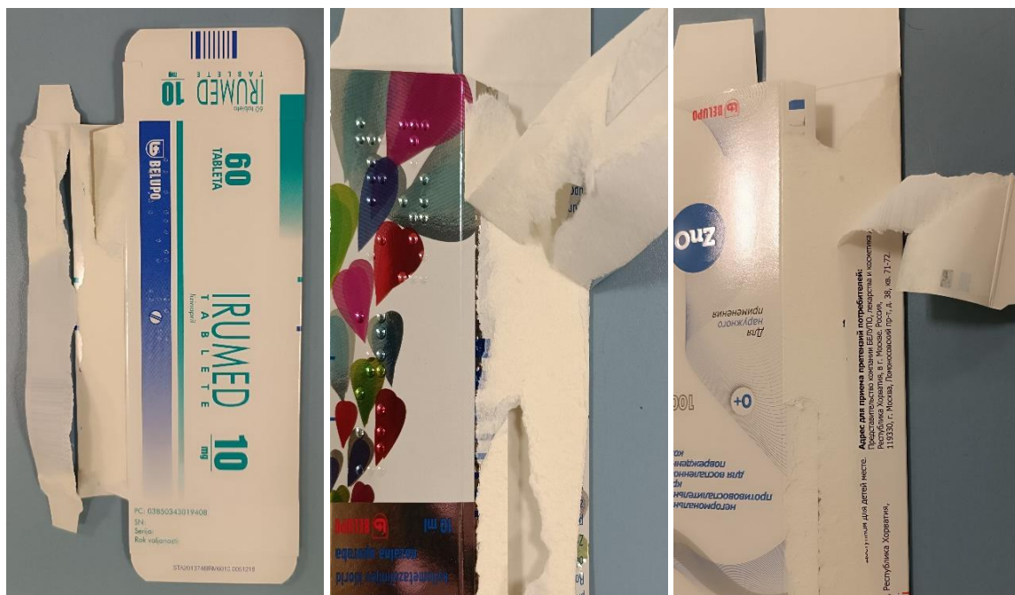
Slika 5.9 Ispitivanje lijepljenja analiziranih kartonskih kutija
