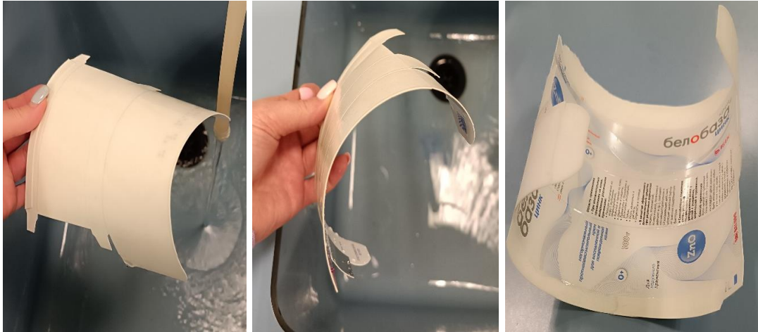
Slika 5.6 Ispitivanje smjera vlakanaca analiziranih kartonskih kutija
