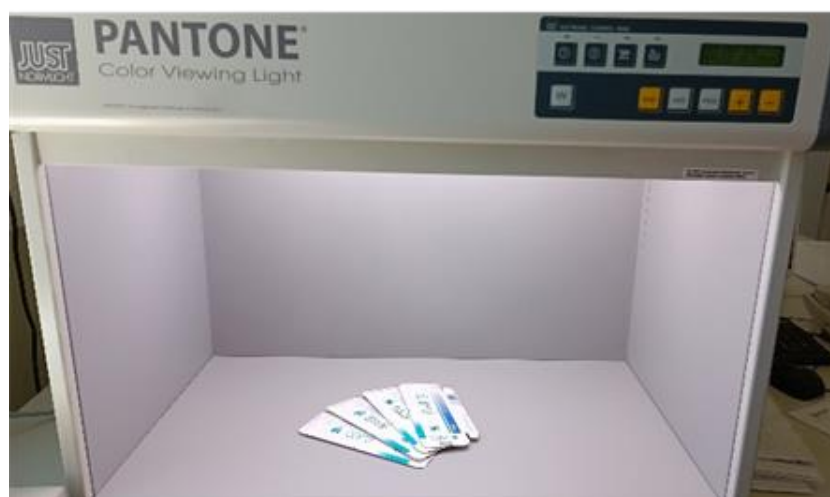
Slika 5.14 Vizualna kontrola zadanih Pantone boja na kutijama u komori s rasvjetom proizvođača Pantone, model 521 PJC/CVL5E
