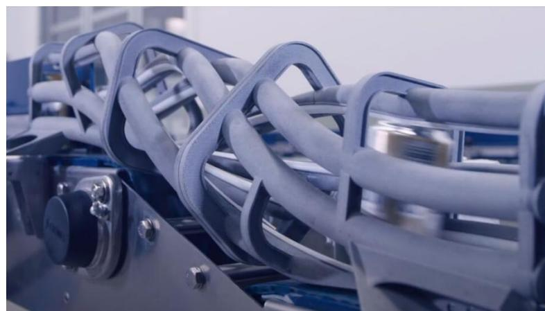
*Slika 3.5. Krones dio za uvrtanje limenki ispisani 3D pisačem*
