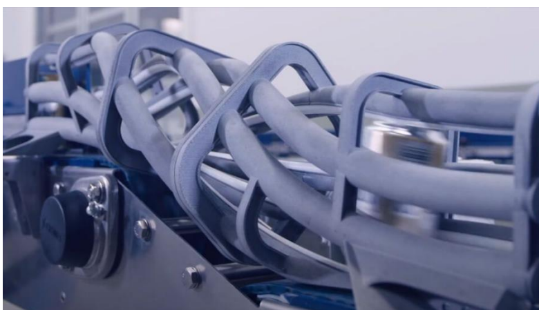
Slika 3.5. Kronos dio za uvrtnje limenki ispisan 3D pisačem
