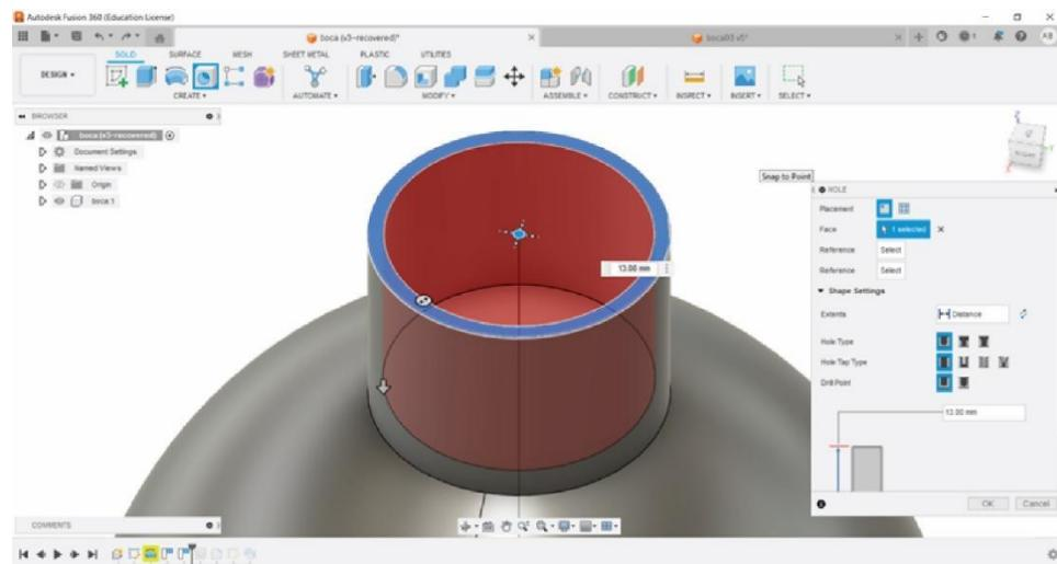
*Slika 5.5. Izrada otvora boce korištenjem alata Hole*
