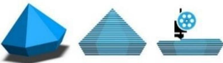
*Slika 4.5. Postupak rezanja CAD 3D modela na slojeve*
