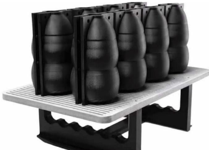
*Slika 3.6. 3D kalupi za boce ispisani korištenjem xPEEK147-Black materijala iz Henkela korištenjem Nexas3D NXE 400 3D pisača*
