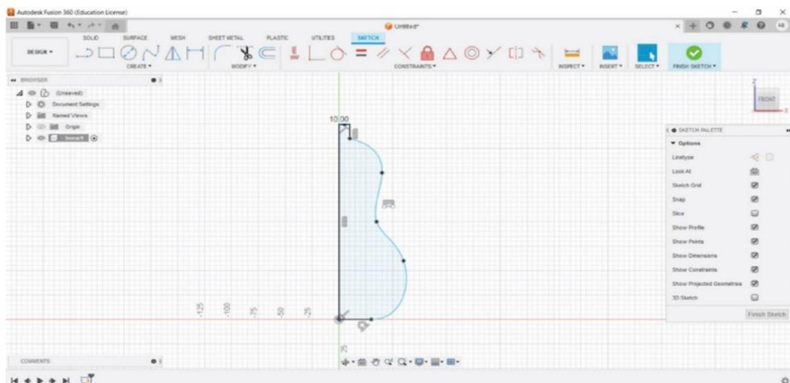
*Slika 5.2. Izrada polovice modela boce uz pomoć alata Line i Spline*
