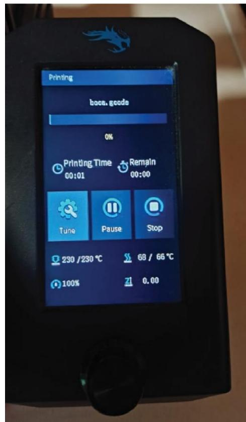
*Slika 5.14. Zaslon pisača na kojem je prikazana temperatura podloge i mlaznice*
