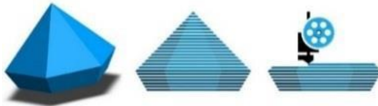
Slika 4.5. Postupak rezanja CAD 3D modela na slojeve
