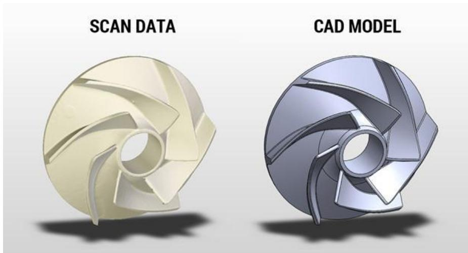
*Slika 4.2. Razlika između modela dobivenih 3D modeliranjem i 3D skeniranjem*
