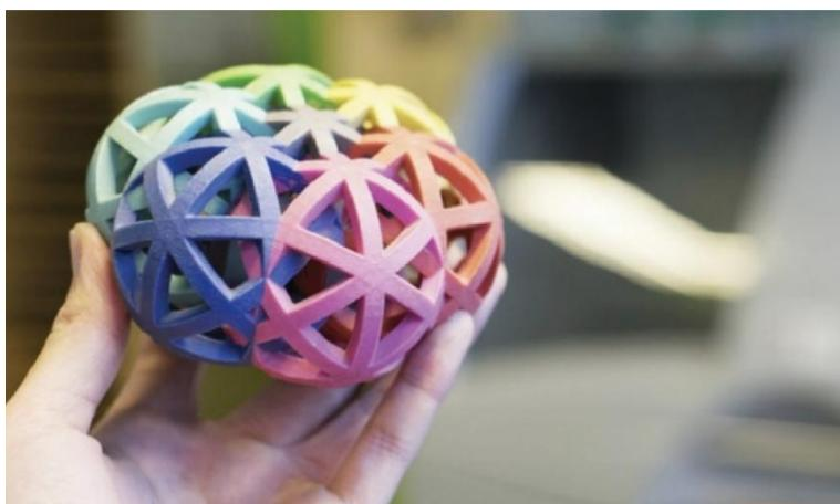
**Slika 2.11.** Model ispisano u boji upotrebom *binder jetting* tehnologije 3D ispisa
