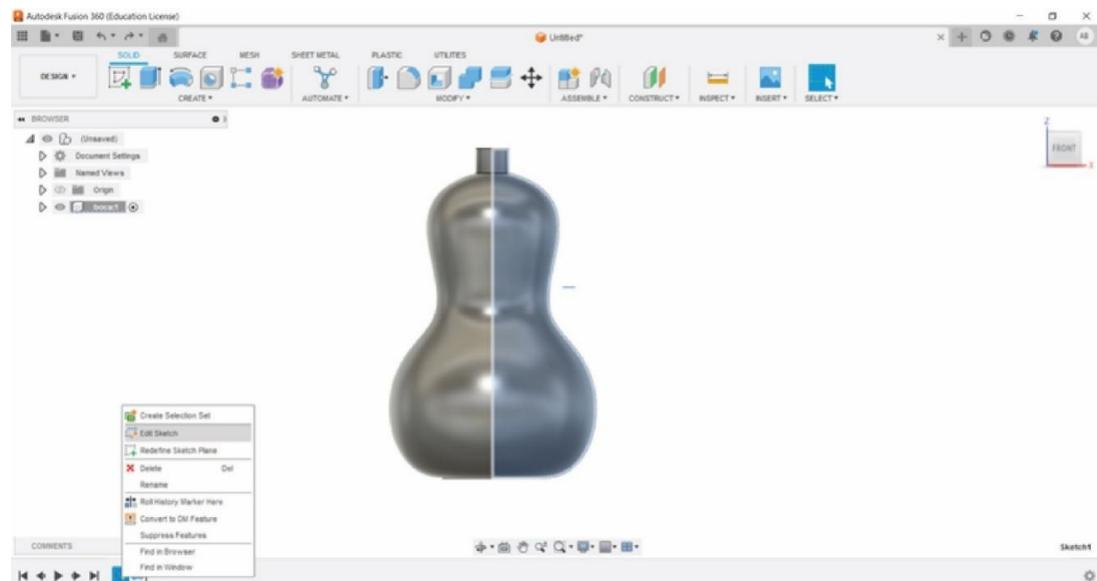
*Slika 5.3. Oblik boce dobiven nakon korištenja alata Revolve*
