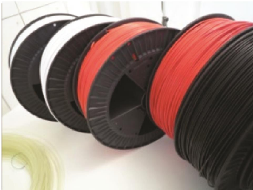
Slika 2.3. Koluti PLA materijala debljine 3 mm koji se koriste za RepRap pisače
