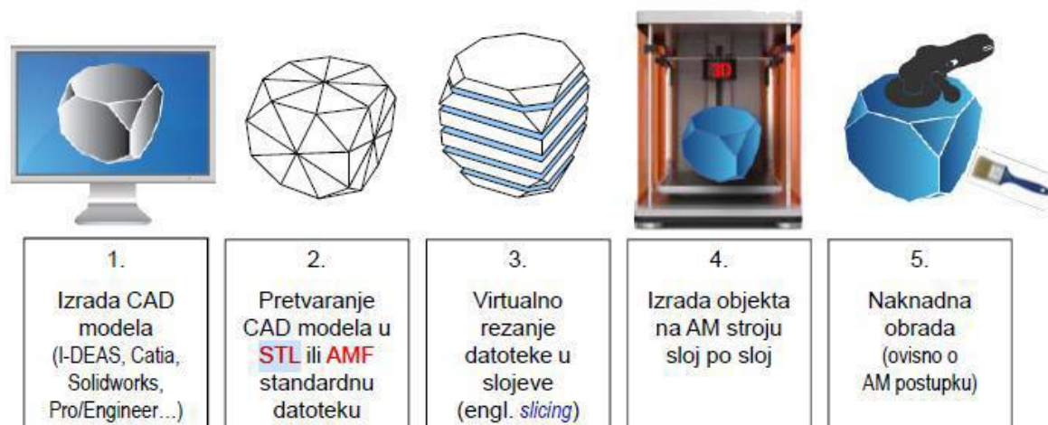
Slika 4.4. Faze izrade modela 3D ispisivanjem
