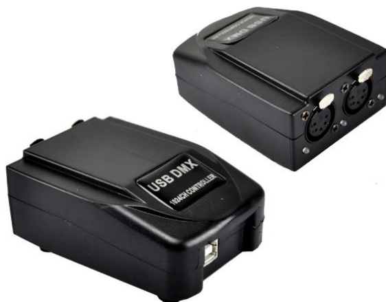
Slika 3.1. Prikaz kontrolera - DMX na USB
