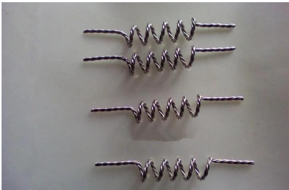
Slika 2.12. Prikaz Volframove niti, hrvatski izumitelj Franjo Hanaman
