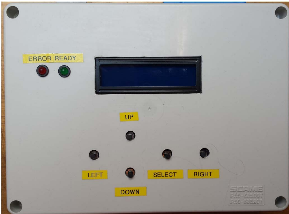
Slika 12: Upravljačka jedinica sustava upravljanja – prednja strana
