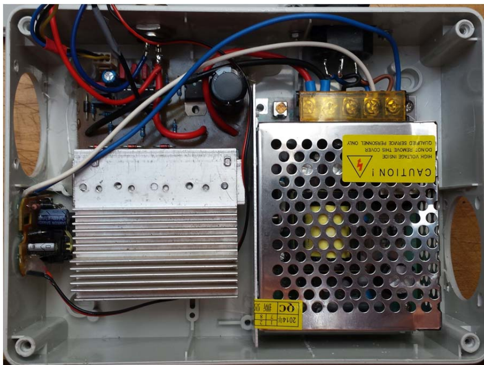
Slika 9: Dijelovi PWM regulatora pumpe
