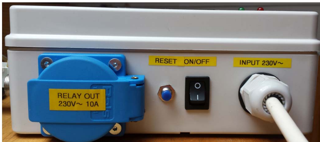
Slika 13: Upravljačka jedinica sustava upravljanja – stražnja strana
