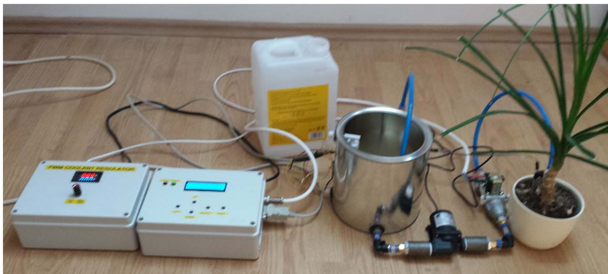
Slika 11: Maketa sustava za automatsko zalijevanje biljke
