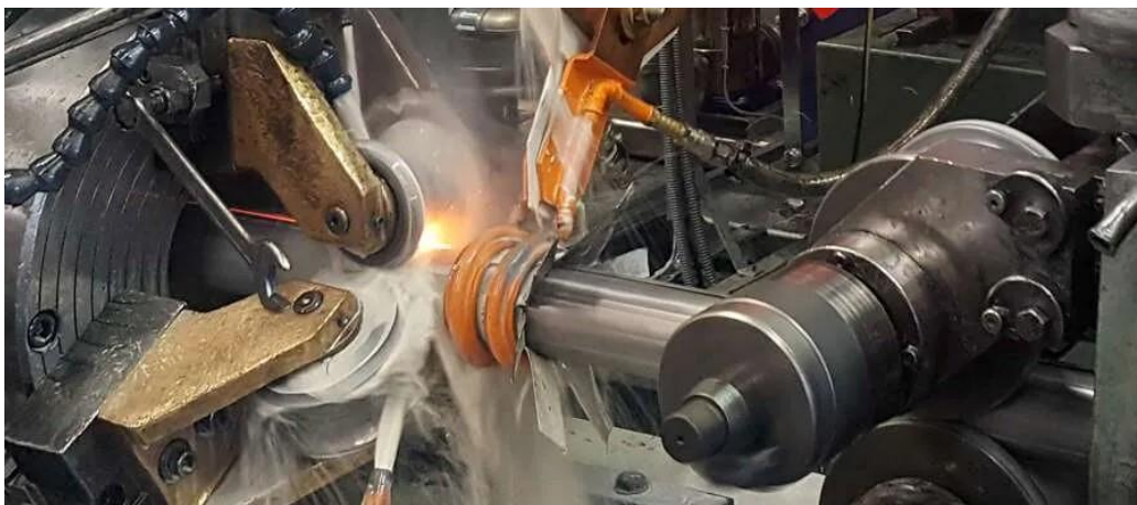
Slika 15. Visoko frekventno induksijsko zavarivanje [20]
