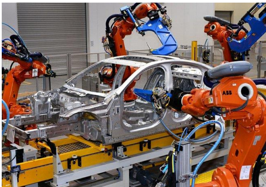
Slika 26. Automatiziran postupak točkastog zavarivanja u automobilskoj industriji [27]
