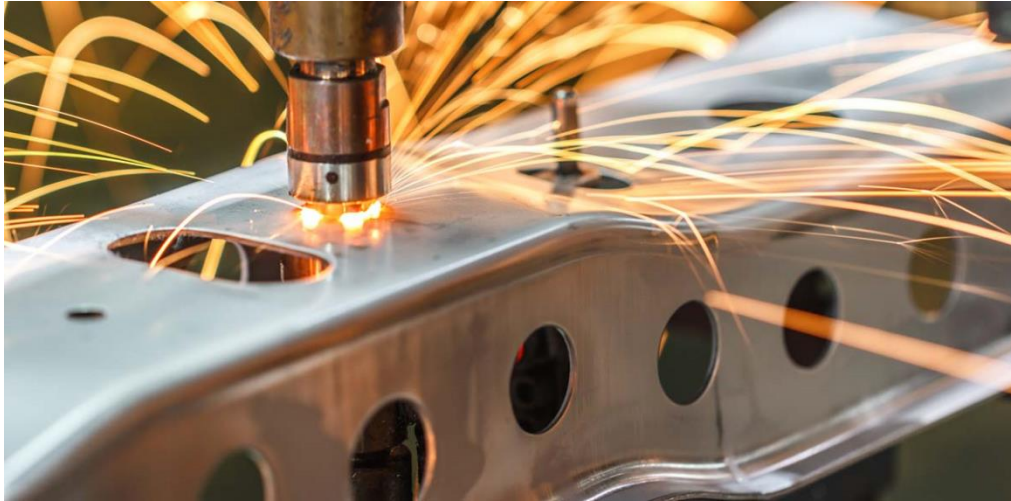
Slika 16. Točkasto elektrootporno zavarivanje [21]
