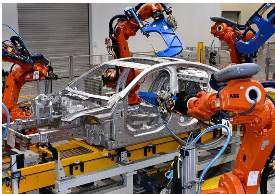
Slika 26. Automatiziran postupak točkastog zavarivanja u automobilskoj industriji [27]
