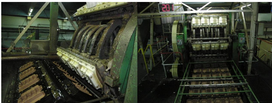
Slika 9. Dotoci pulpe u strojno korito u Hartmannu
