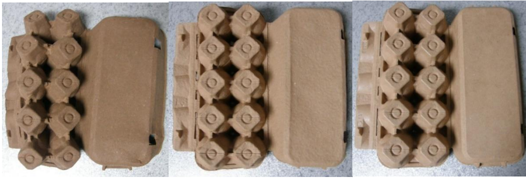
Slika 11. Polugotova ambalaža u različitim fazama proizvodnje: (a) prije sušenja; (b) nakon sušenja; (c) nakon prešanja.
