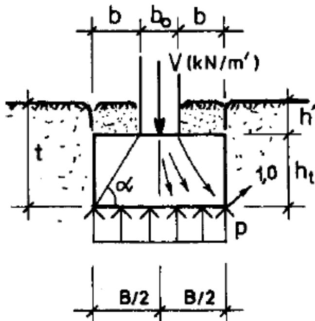
Sl. 6.1.4. Trakasti temelj od nearmiranog betona [9]
