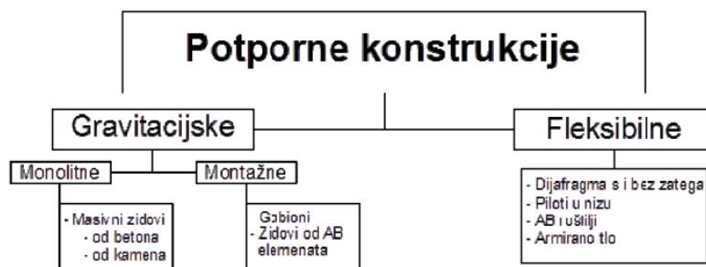
Sl.3.2. Osnovna podjela potpornih konstrukcija [16]
