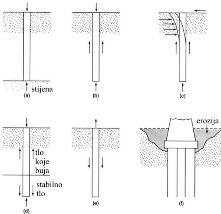
Na slici 4.3.1. (a) je piloti koji opterećenja prenosi kroz loše tlo u čvrstu stijensku podlogu, na vrh, bez sudjelovanja trenja po plaštu. Na slici 4.3.1. (b) pilot prenosi opterećenje dijelom na vrh
