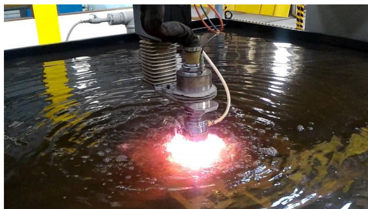
Slika 3.2 Postupak podvodnog plazma rezanja [16]
