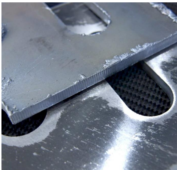
Slika 4.2 Izrezani segmenti prije i nakon uklanjanja troske [17]
