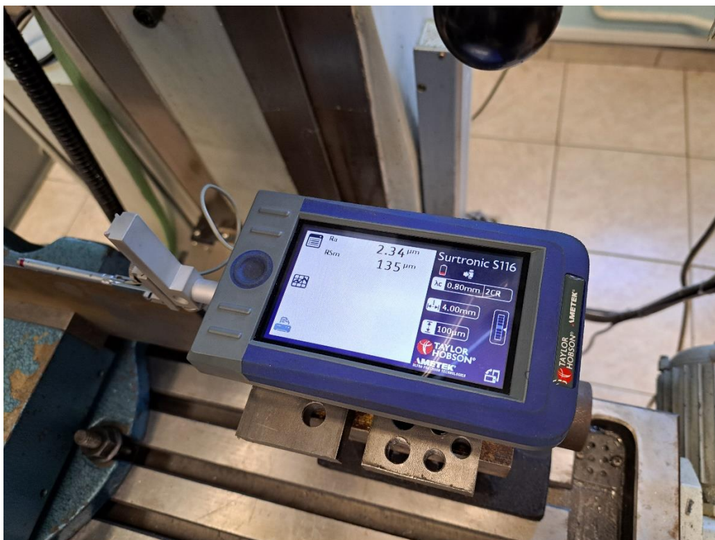
Slika 7.12 Prikaz rezultata na led zaslonu uređaja nakon izmjerene hrapavosti jednog od reza (fotografirano na Sveučilištu Sjever)
