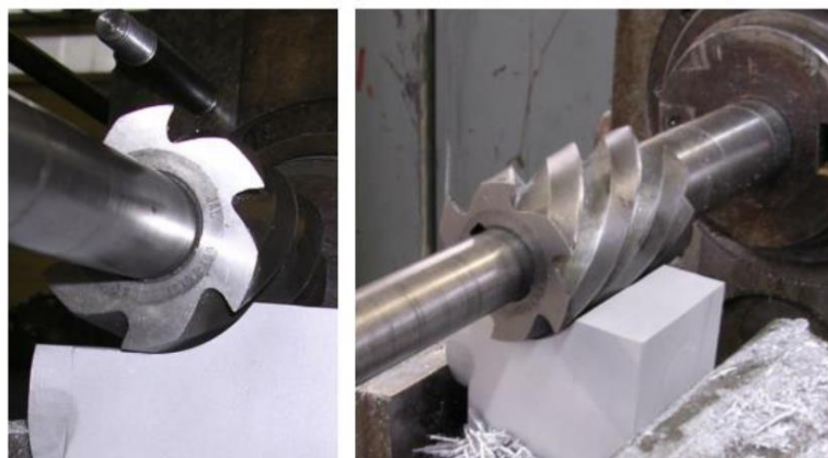
Slika 2.10 Obodno ravno istosmjerno glodanje [13]
