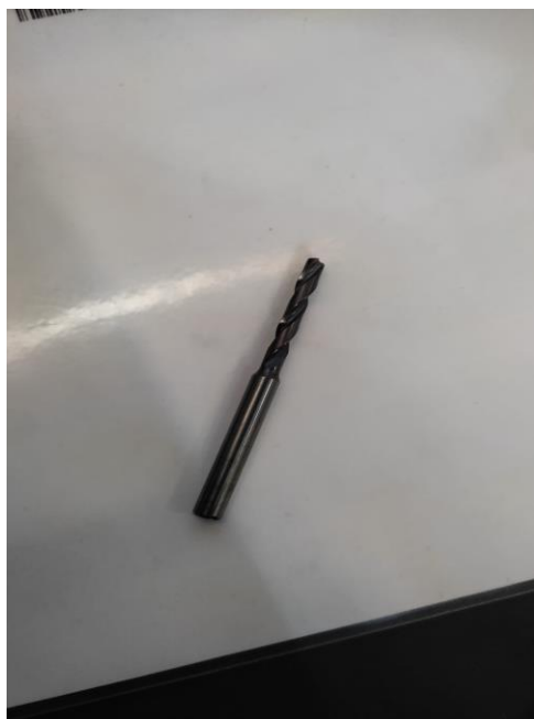
Slika 5.30 Svrđlo za izradu provrta (osobne slike)
