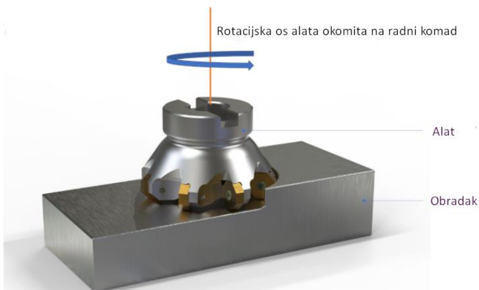
Slika 2.11 Prikaz čeonog glodanja [14]
