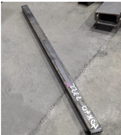
Slika 5.25 Sirovac 1000x40x40 mm (osobne slike)
