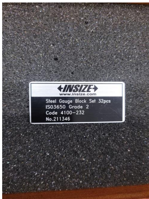
Slika 5.34. Insize mjerke prema normi (osobne slike)
