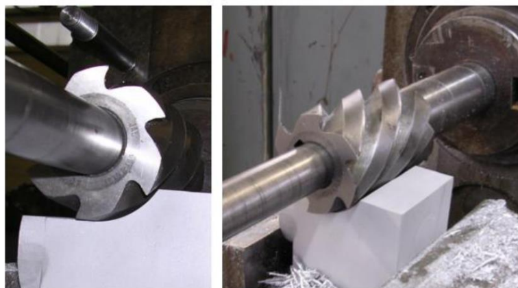
Slika 2.10 Obodno ravno istosmjerno glodanje [13]
