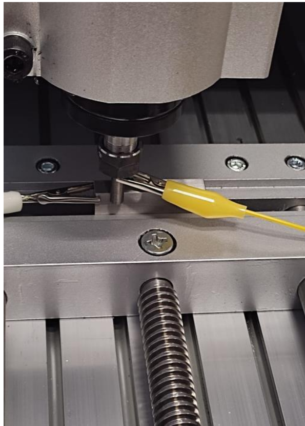
Slika 5.38. Planparalelna mjerka u kontaktu s zaticom (osobne slike)
