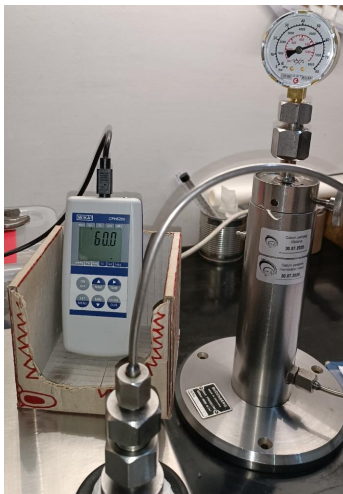
Slika 16 Umjeravanje mjerila u mjernom području 0/80 bar – prikaz etalona i mjerila Slikano 27.6.2023.
