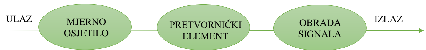
Slika 9 Struktura mjernog pretvornika
