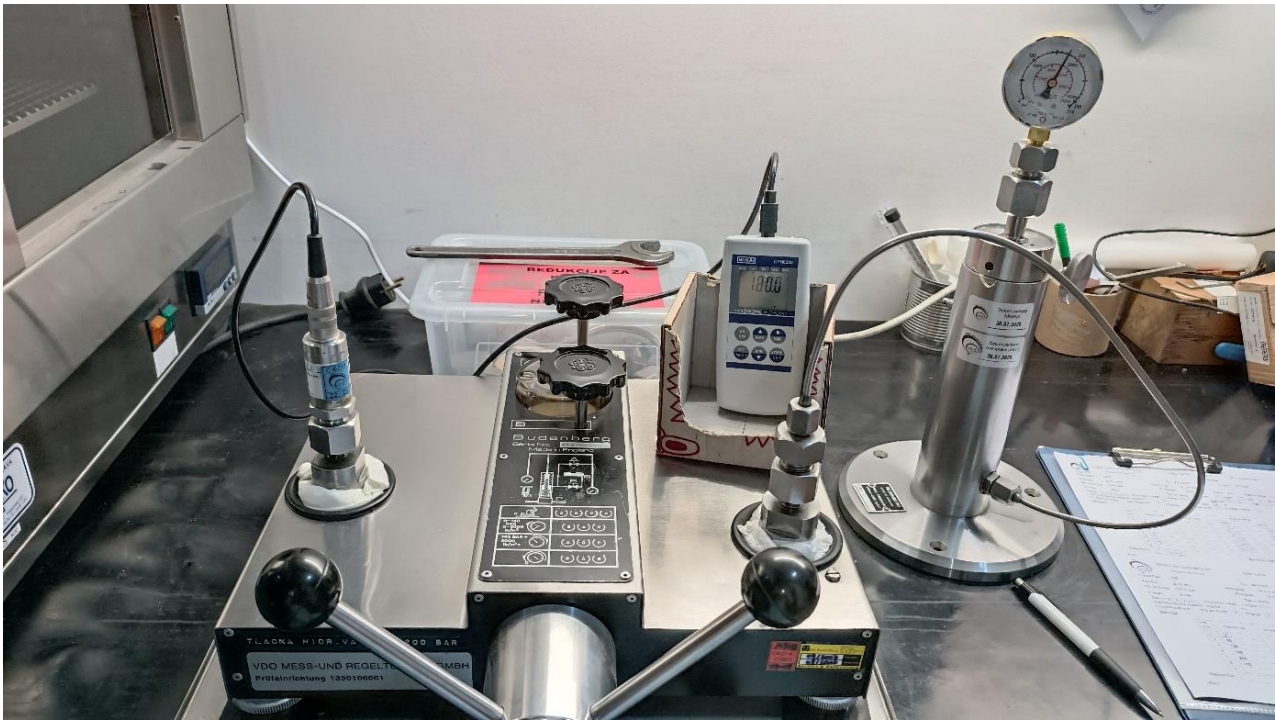
Slika 17 Umjeravanje mjerila u mjernom području 0/315 bar – prikaz narinutog tlaka od 180 bar
