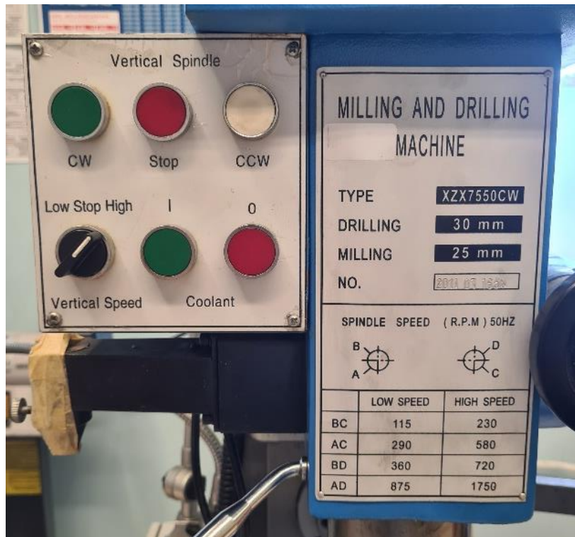
Slika 4.9 Postavke brzine rotacije alata (High speed AD – 1750 okretaja/min) i smjera rotacije alata (CW i CCW)
