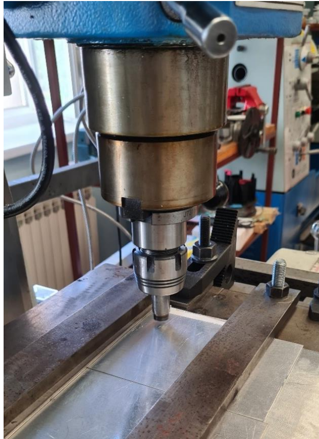
Slika 4.10 Pozicioniranje alata iznad radnog komada
