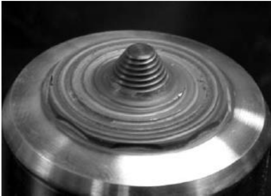
Slika 3.9 Konveksno čelo alata s navojima (utorima) [13]
