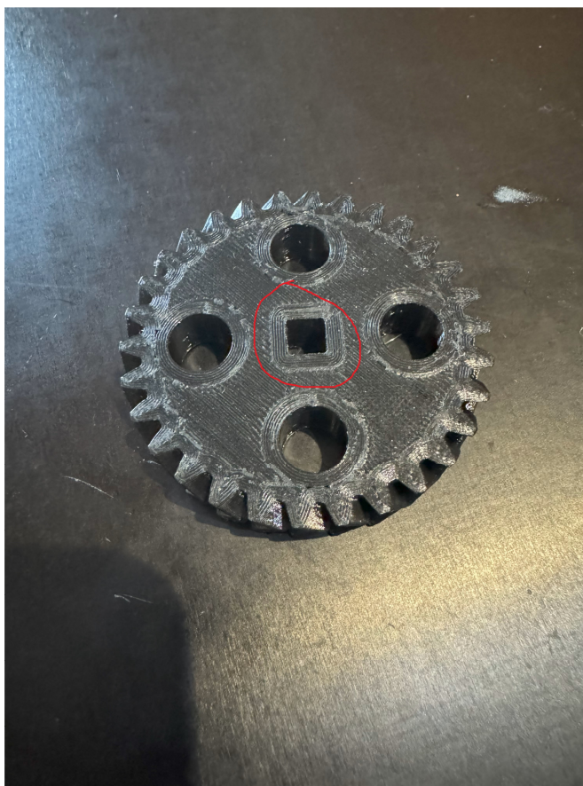
Slika 24 Prikaz nepreciznosti pisača kod ispisa kvadratnih otvora
