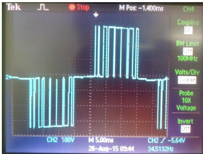
Slika 9.1 Valni oblik napona na izlazu iz pretvarača pri frekvenciji od 35 Hz
