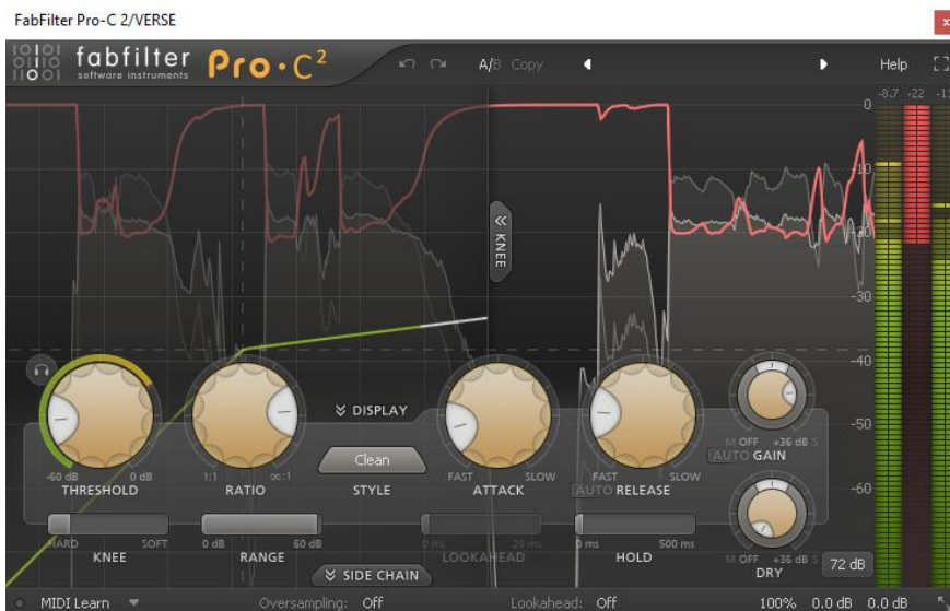
Slika 33. Paralelna kompresija na vokalu
