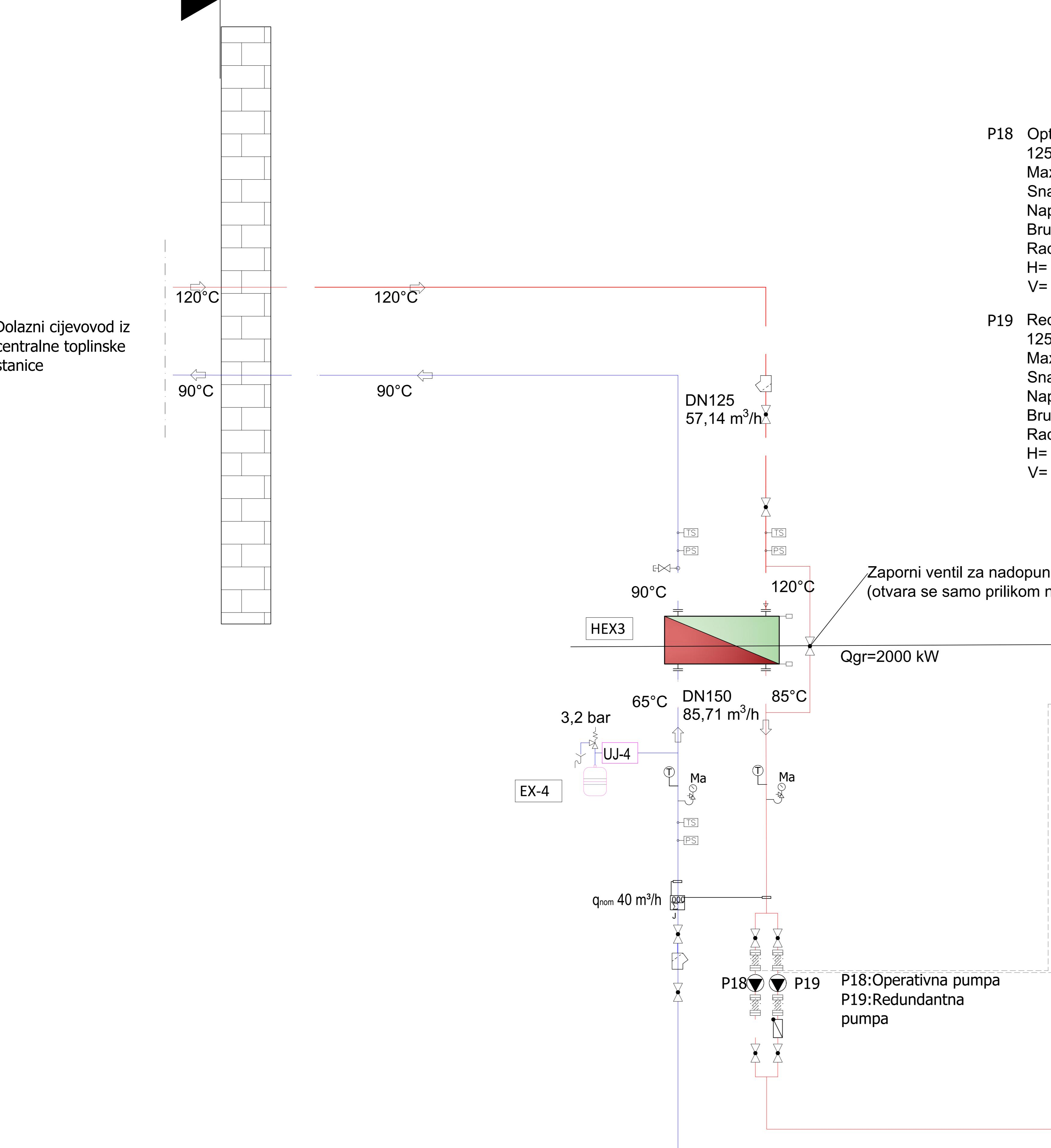
P18 Optična pumpa, proizvod kao tip CRN 125-2-1 A-P-A-E-HQQE
