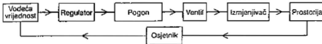
Slika 3.1 Osnovni elementi regulacijskog kruga [15]
