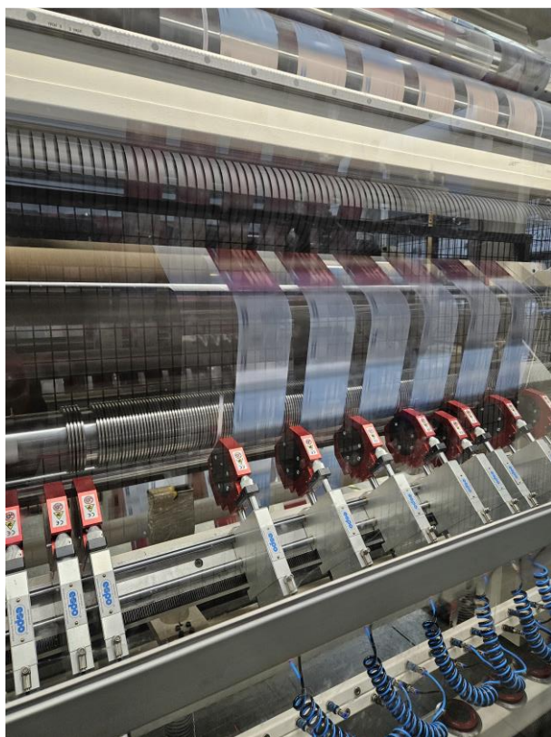
Slika 24 Rezanje jumbo role u konačni proizvod (Izvor autora)
