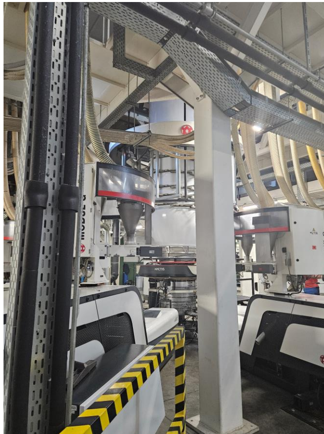
Slika 17 Windmüller & Hölscher ekstrudor (Izvor autora)
