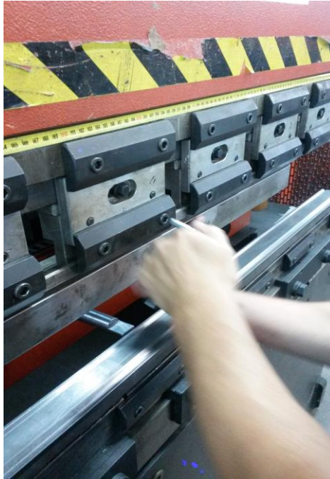
Slika 7.1 Otpuštanje vijaka imbus ključem
