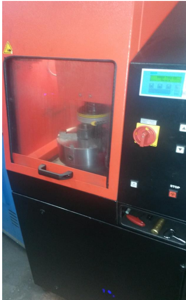
Slika 6.9 Brušenje matrice na CNC brusilici
