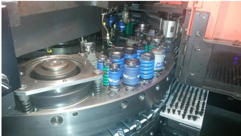
Slika 6.4 Revolver od stroja KING 358
