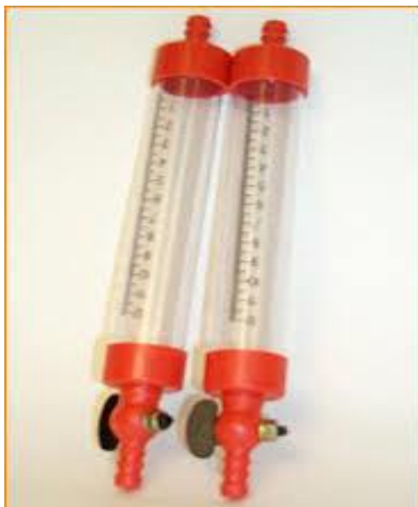
Slika 4. Hidrostatski nivelman metoda temeljena na gumenim cijevima
