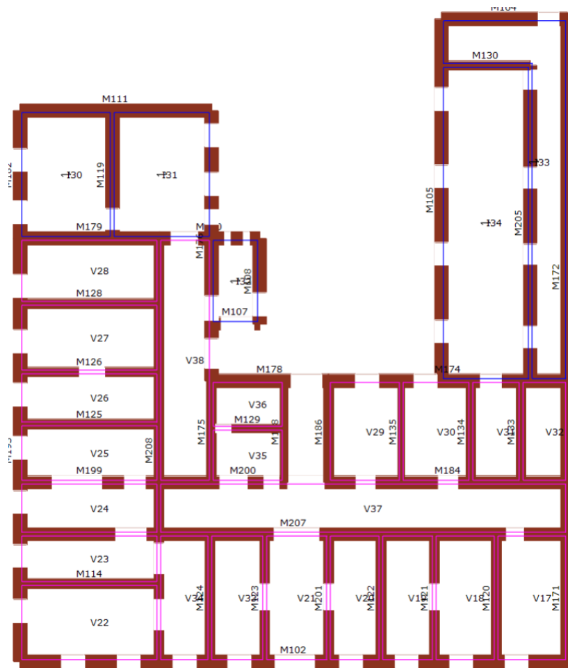
Slika 8.3 Tlocrt prizemlja (grafički prikaz razine iz programa 3Muri)
