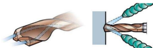
Slika 5.14 Svrdlo s dovodom SHIP-a [31]
