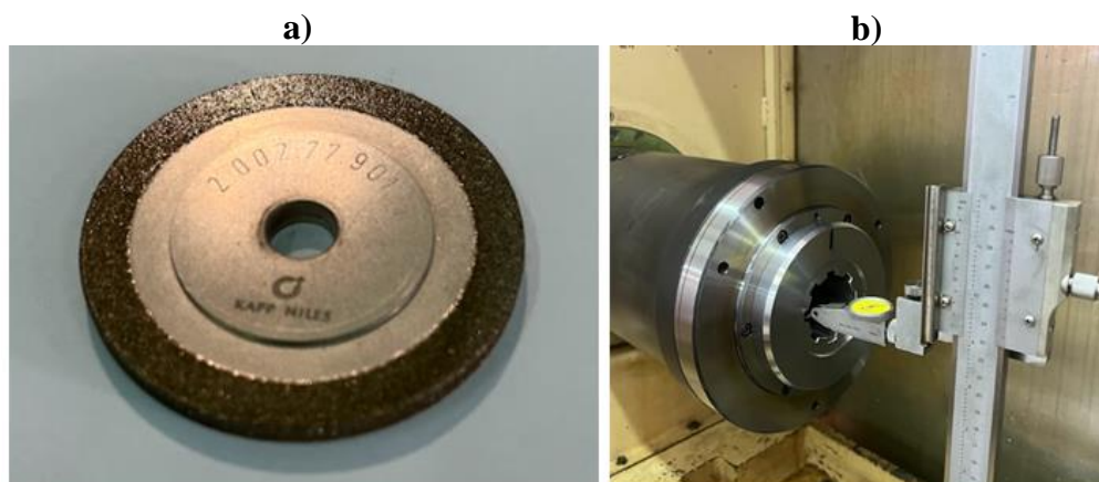
Slika 7.53 Prikaz a) brusne ploče b) mjerenja komada mjernom urom [36]
