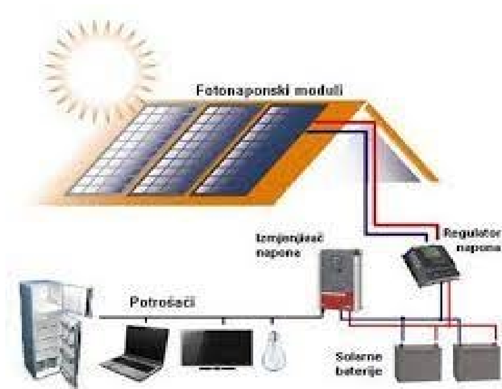
Slika 13. Samostalni fotonaponski sustav [10]
