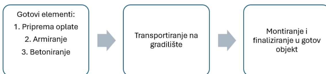
Slika 1.1. Shematski prikaz proizvodnje elemenata u stacionarnom pogonu
