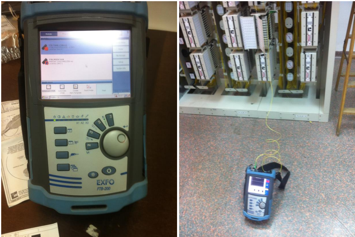
Slika 5.1. Mjerni instrument EXFO FTB-200 (izvor: autor)
