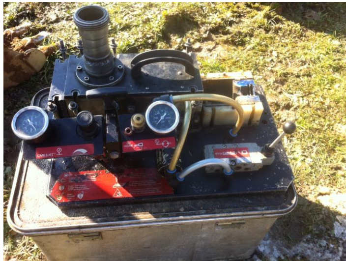
Slika 3.9. Aparat za upuhivanje optike, Cablejet (izvor: autor)
