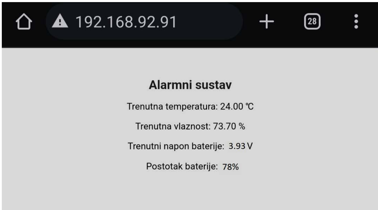
Slika 5.2 Prikaz lokalnog web sučelja
