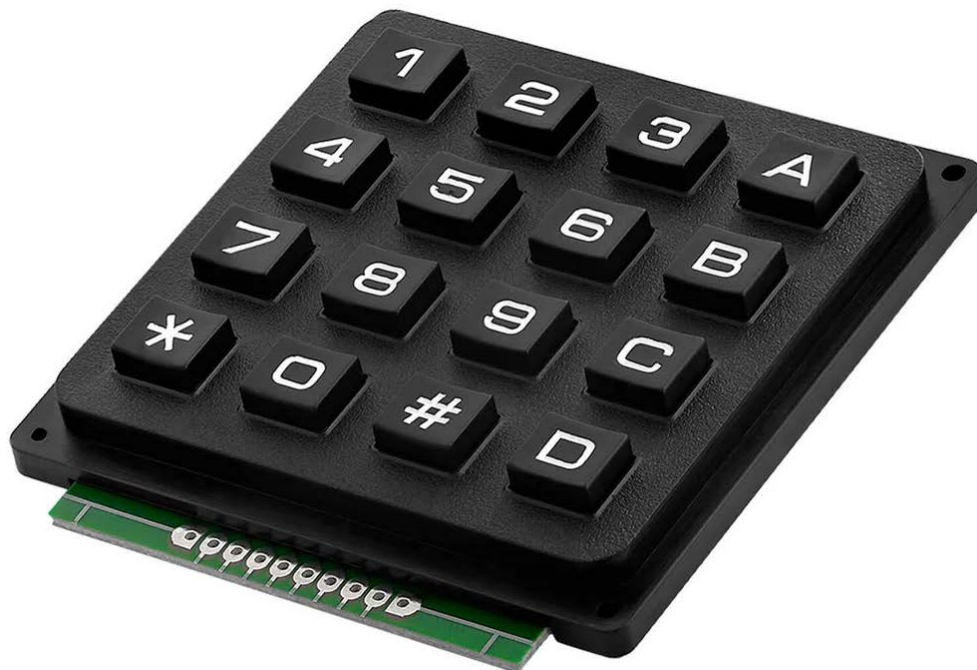
Slika 4.8 Matrična tipkovnica 4x4 [7]
