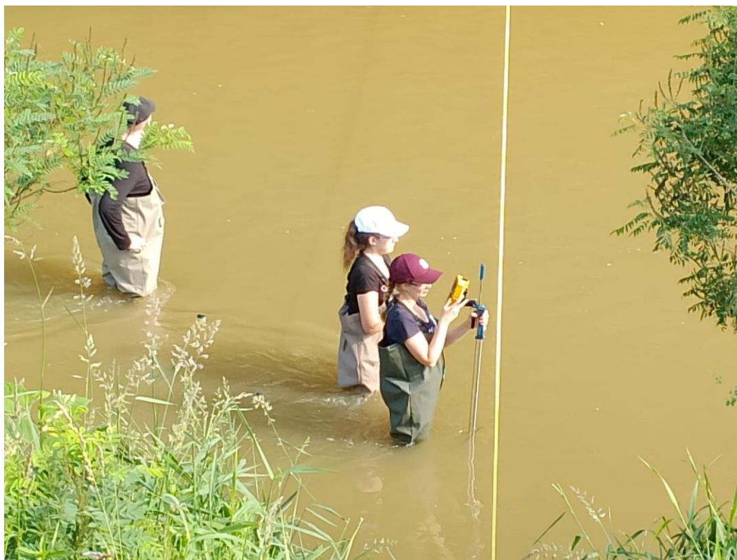
Slika 4.17. Mjerenje ADV-om – poprečni profil 1 [5]
