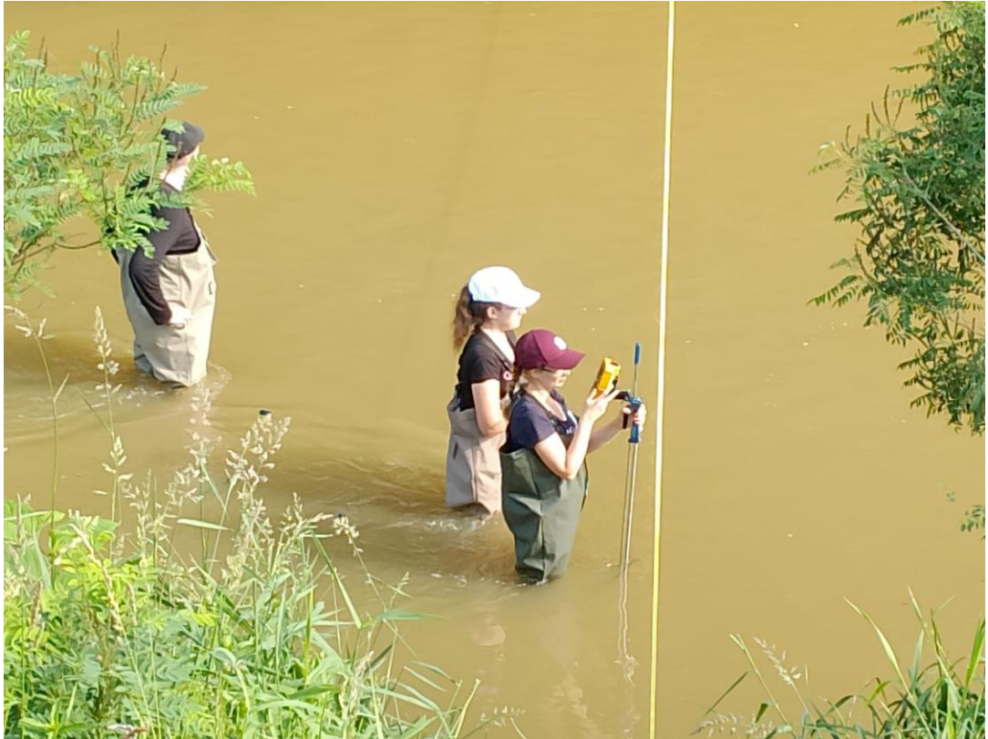
Slika 4.17. Mjerenje ADV-om – poprečni profil 1 [5]
