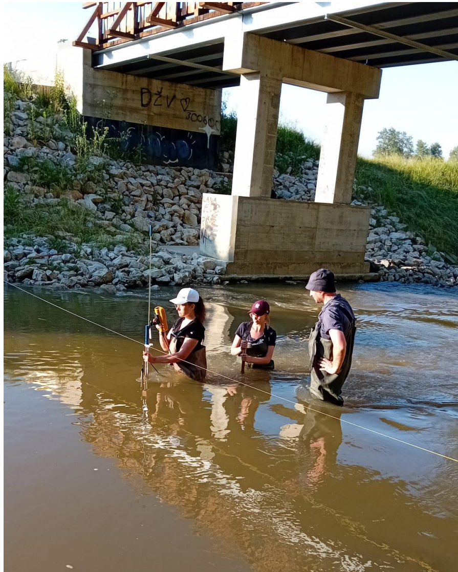
Slika 4.19. Mjerenje ADV-om – poprečni profil 2 [5]
