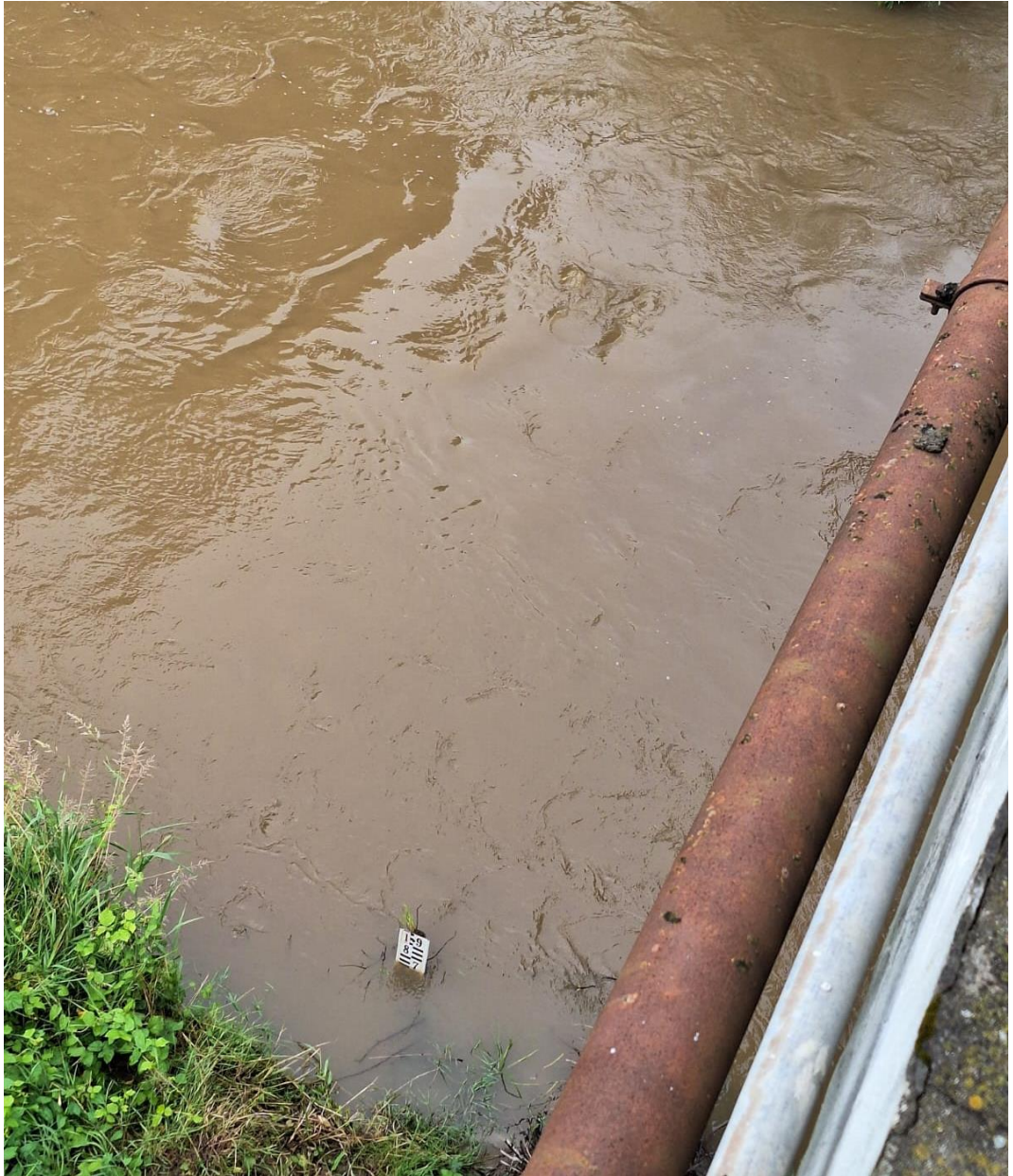
Slika 1.3. Mjerna letva na lokaciji Tuhovec [5]
