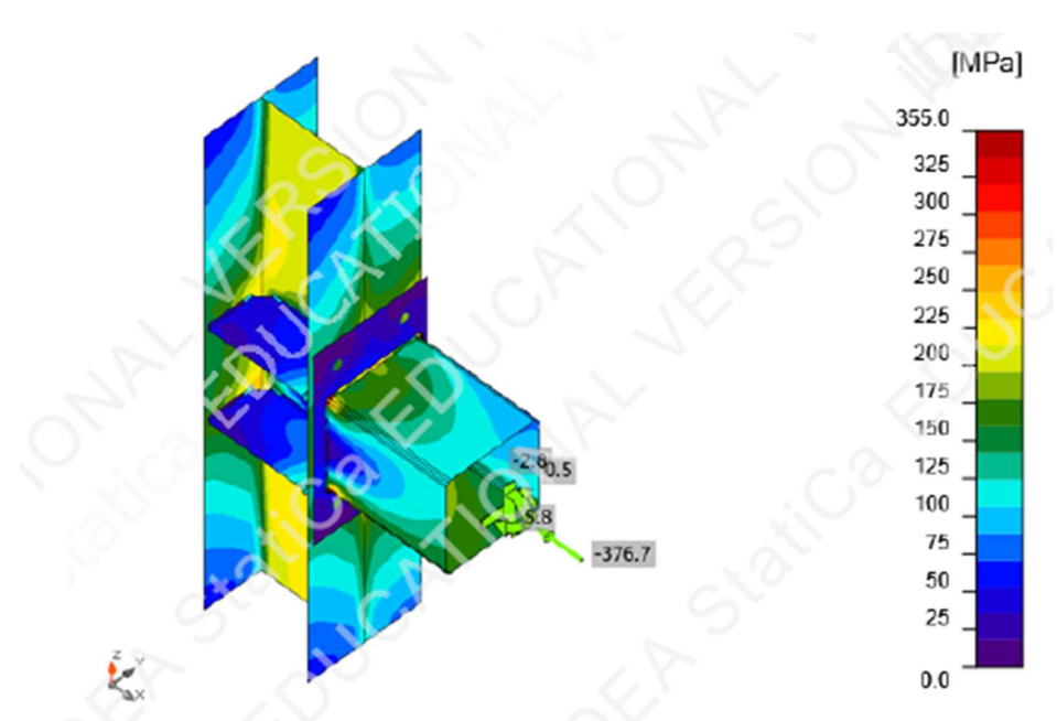
Slika 4.7.2.3.: Prikaz naprezanja spoja stup - rešetka
