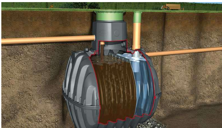
Slika 15. Postrojenja za pročišćavanje otpadnih voda
