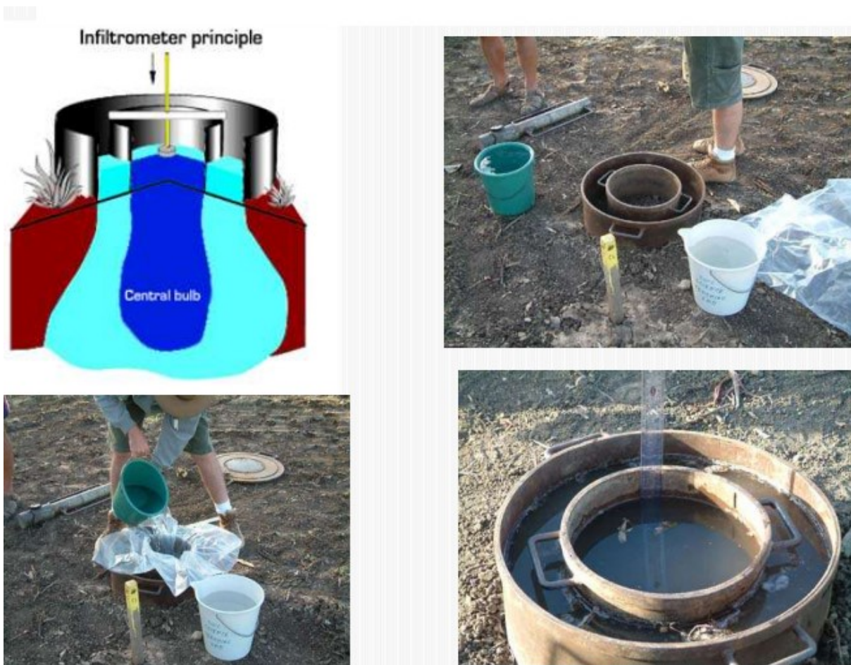
Slika 3. Mjerenje infiltracije double – ring infiltrometrom
