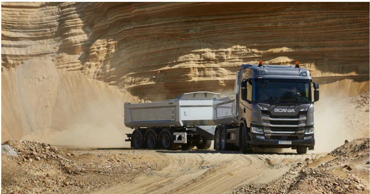
Slika 32 Scania G serije s nadogradnjom otvorenog kiper sanduka i vuče
